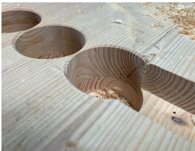
Löcher made by LEUCO: Klares Testresultat für den t3-System Fräser – exzellente Fräsqualität, feine Kanten, keine Brandspuren. Und die 45 Grad Fase an der oberen Kante macht das innovative Werkzeug in einem Arbeitsgang gleich mit.
