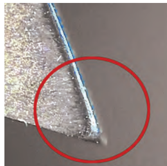
Hat Biss auf Kurzstrecke: Die Kantenverrundung eines Hartmetall-Sägezahns nach 4 km Schnittweg.
