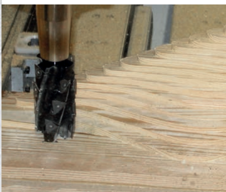
Die vom LEUCO t3-System-Schafffräser erzeugten Flächen und Kanten in Esche sind glatt und ausrissfrei.
