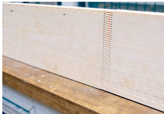
Die Qualität der Zinkenverbindungen spielt bei Theurl eine zentrale Rolle. Seit dem Einsatz der LEUCO-Zinken mit Solid34-Schneidstoff und Topcoat-Beschichtung verzeichnet Theurl eine nahezu gleichbleibende Zinkenqualität über die gesamte Standzeit von rund 600.000 Zyklen
